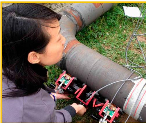
Que ce soit en mode Pulse Echo ou Pitch Catch, le scanner génère des ondes guidées le long d'un tube ou d'une plaque et permet d'inspecter les réflexions engendrées par des corrosions ou des défauts jusqu'à 5 m devant le ou les capteurs. Idéal pour l'inspection de tubes ou plaques où il n'y a pas d'accès direct à la zone inspectée.
